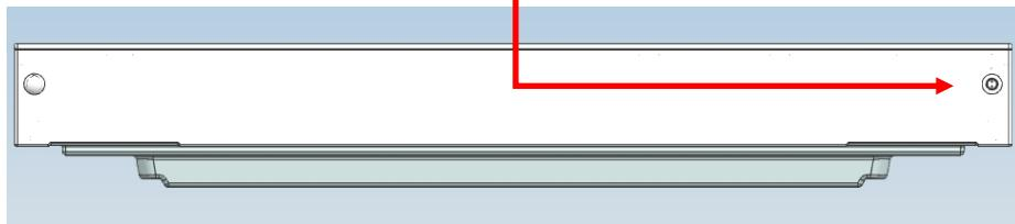
b. Use uma ferramenta para remover os parafusos da alça de parada, conforme mostrado na figura abaixo, e arme-os no outro lado da porta.
