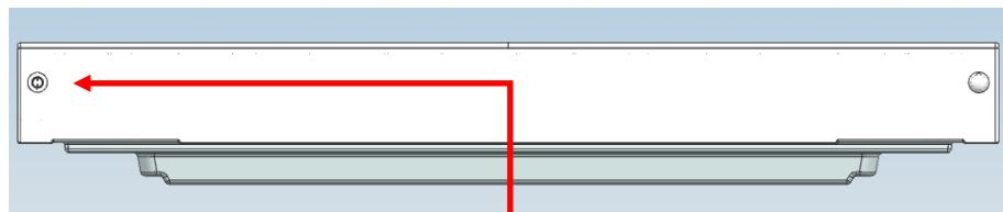
b. Use una herramienta para quitar los tornillos del asa del tope como se muestra en la figura a continuación y luego armelos al otro lado de la puerta.
