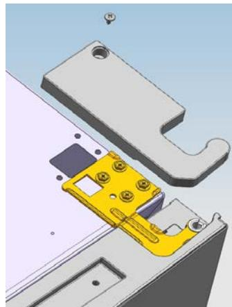
b. Use uma ferramenta para remover os 4 parafusos do topo. Levante a tampa da porta e pequena tampa na porta
