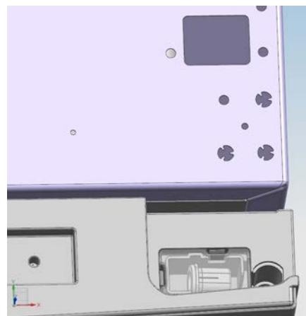
d. Use uma ferramenta para remover os 2 parafusos conforme mostrado na figura abaixo para remover a tampa do orifício na parte superior do gabinete e remover a linha de comunicação do gabinete do orifício.
