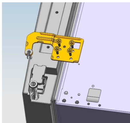
c. Inserte el casquillo de la puerta y la línea de comunicación de la puerta en el orificio de la puerta y luego coloque la tapa de la tapa pequeña.
