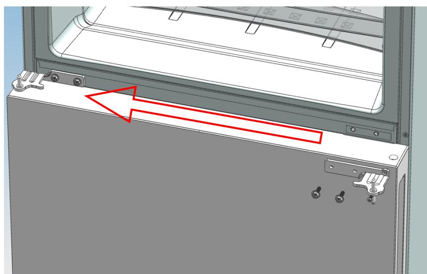
3, coloque a porta da geladeira e monte a dobradiça superior esquerda no outro lado do gabinete; use uma ferramenta para apertar os 4 parafusos para fixar a dobradiça superior.
