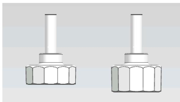
2, coloque a porta do freezer e gire a meia articulação 180 °C e, em seguida, arme-a no outro lado do gabinete; use uma ferramenta para apertar os 3 parafusos para fixar a dobradiça do meio.
