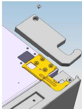
b. Use una herramienta para sacar los 4 tornillos de la parte superior. Levante el casquillo de la puerta y la tapa de la tapa pequeña en la puerta
