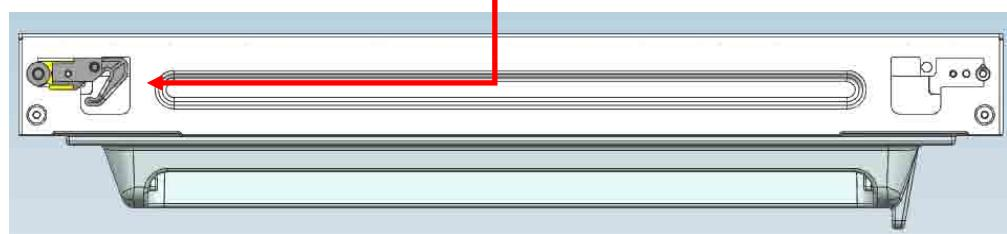
c. Use uma ferramenta para remover o eixo e os dois plugues na dobradiça inferior e, em seguida, coloque-os na posição mostrada na figura abaixo.
