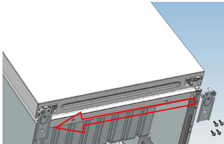
b. Monte o pé dianteiro ajustável mais curto na parte inferior da dobradiça e ajuste a altura do pé para que o refrigerador permaneça nivelado.
