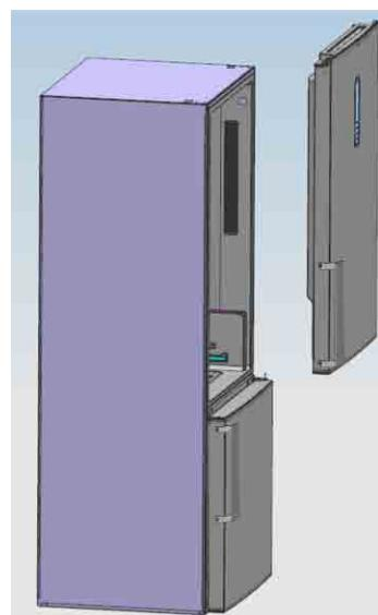
1. a. Use una herramienta para quitar los 3 tornillos de la cubierta de la bisagra del medio y luego retire la bisagra del medio.
