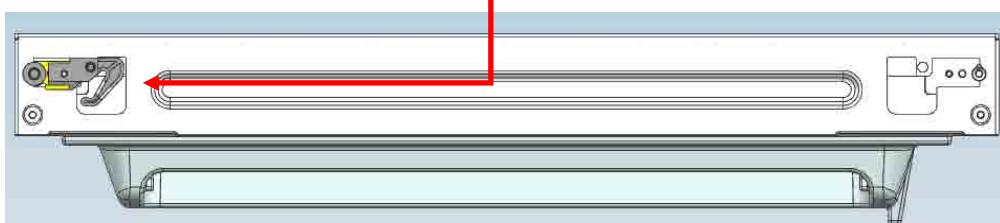
c. Use una herramienta para quitar el eje y los dos tapones en la bisagra inferior y luego, colóquelos en la posición que se muestra en la figura a continuación.
