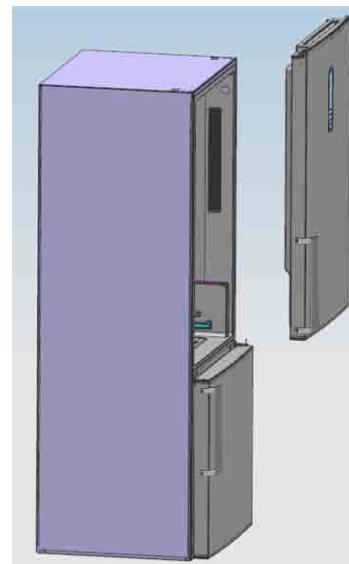
1. a. Use uma ferramenta para remover os 3 parafusos da tampa da dobradiça do meio e, em seguida, remova a dobradiça do meio.
